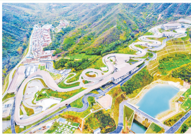
国家高山滑雪中心、国家雪车雪橇中心:均位于北京市延庆区小海坨山区域。前者是目前世界上难度最大的比赛场地之一,赛时承担高山滑雪项目;后者是中国首条雪车雪橇赛道,赛道采用“全遮阳”系统,可最大限度降低能源消耗,将承担冬奥会雪车、钢架雪车和雪橇项目的比赛。
