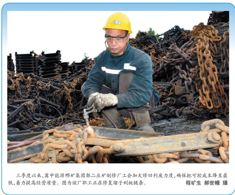
三季度以来,冀中能源邯矿集团郭二庄矸石场工会加大修旧利废力度,确保把可控成本降至最低,着力提高经营质量。图为该厂职工正在修复溜子刮板链条。程衍生 郝世慢 摄
