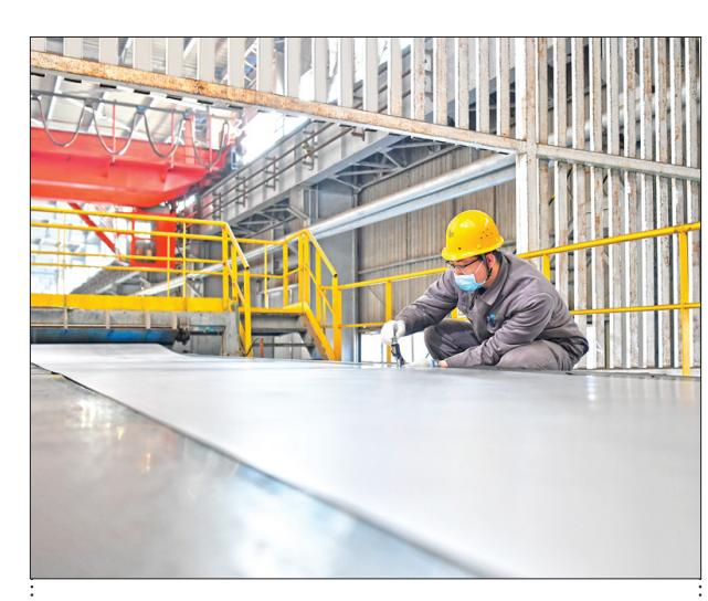
2月20日,河钢唐钢卷板事业部青年技术人员正在抽查高强结构级镀锌产品尺寸精度。该事业部团委认真贯彻落实集团2021年工作会议精神,引导青年技术人员围绕提升高效、高潜力产品品质开展创新攻关,积极对接用户需求,通过调整板型控制曲线、改进自动变规格程序、优化酸轧机组乳化液循环系统改造,进一步提升“双高”产品板型精度和带钢表面质量,提升产线盈利能力。赵辉 摄
