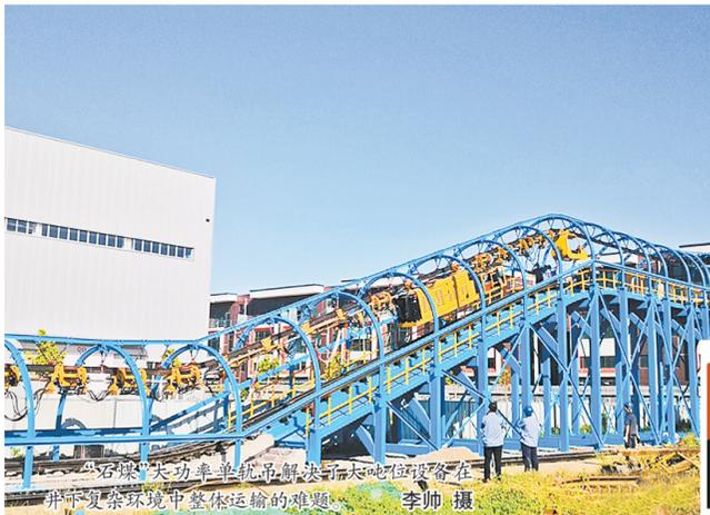
石煤机“大功率单轨吊”解决新大吨位设备在井下复杂环境中整体运输的难题。李帅 摄
