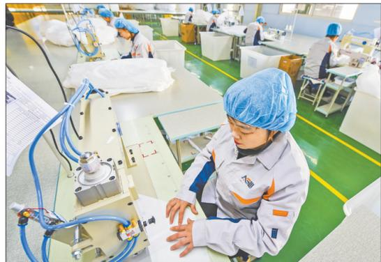
12月26日,在故城县一家移动式保护车衣生产企业,工作人员在利用超声波热合机缝接车衣。今年以来,故城县引进专利技术、采用环保原材料生产的车衣产品防护性能高,可有效防止汽车在运输途中漆面被划伤。目前,该县年产移动式车衣10万套,可实现年销售收入5000万元,产品出口瑞典、美国、德国等欧美国家。新华社记者 李晚果 摄
