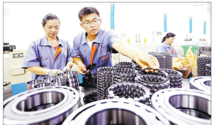
近日,位于临西县经济技术开发区的河北奔克轴承公司员工利用检测仪器对轴承套圈的内外径进行检测。 该公司依托国际领先的计量检测仪器和研发设备设立精密轴承技术研发中心,持续培育新动能,不断提升核心竞争力。其自主研发的精密角接触轴承、精密圆柱滚子轴承、球面滚子轴承、带座外球面轴承单元等产品远销俄罗斯、泰国、印度、日本等20多个国家和地区,广泛应用于高端装备和通用机械领域。 记者 任光阳 通讯员 张玉坤 摄
