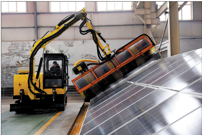
日前,一种新型光伏太阳能板智能清洗车在宣化泰达机械装备制造有限公司研发成功,并获得国家专利,即将量产。该车采用超声波传感、水平传感等技术进行数据采集,应用超声波探头准确定位辊刷,全液压底盘,可灵活行走转弯超爬坡,能适应各种复杂路況,实现了智能化运行。该车每台每天可清洗光伏板2兆瓦,超过人工清洗效率10倍以上。陈晓东 摄
