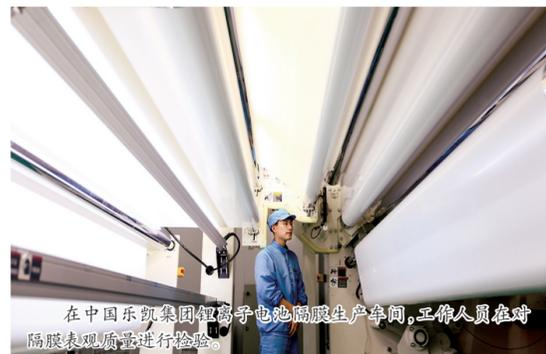
在中国乐凯集团锂离子动力电池生产车间,工作人员在对隔膜表观质量进行检验。
