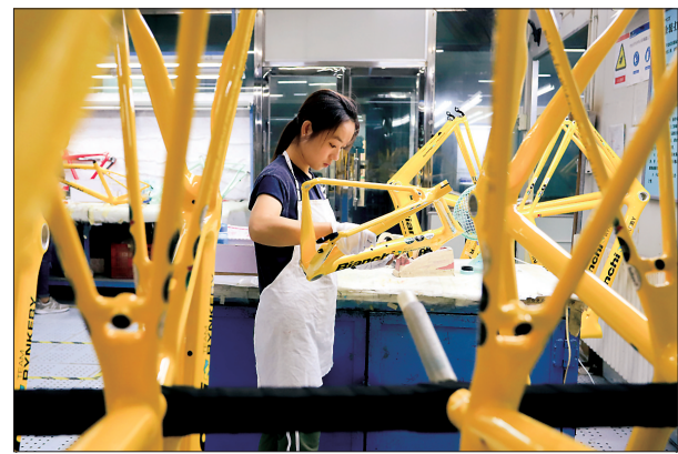
芦台经济开发区作为国家级自行车零部件产业基地,以新材料的应用引领产业升级,碳纤维自行车零部件生产加工工艺在行业技术领先。图为唐山金亨通碳纤维科技有限公司员工正在对碳纤维车架表面进行水标作业。
