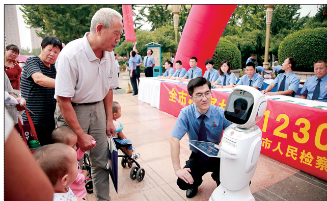
近日,桥西区检察院在全省率先引进的案管实体机器人正式上岗工作。该案管机器人配备内置高拍仪、光盘刻录设备、身份证识别系统等,可实现人机对话、法律咨询、普法宣传、业务引导、身份信息采集、律师阅卷等功能与服务。房凯旋 摄
